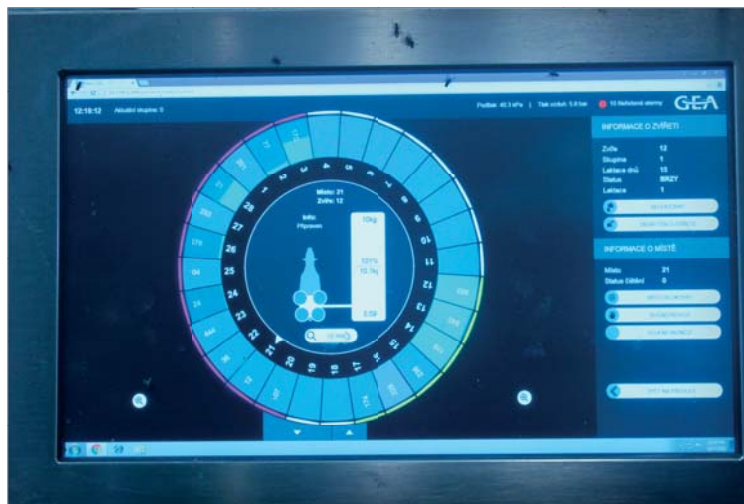
Podle barevného rozlišení na monitoru chovatelé mají přehled o tom, jaká skupina krav se aktuálně dojí, i o průběhu dojení
